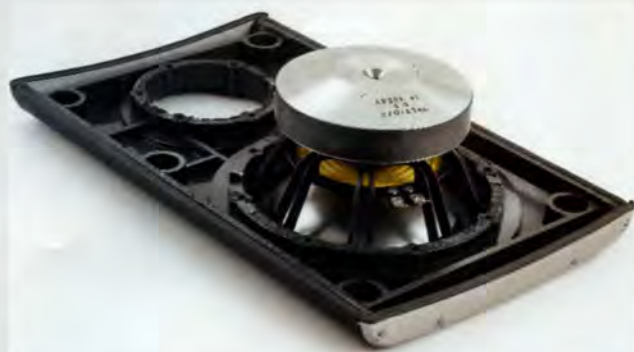
Particolare della struttura del pannello anteriore e del mid-woofer.
